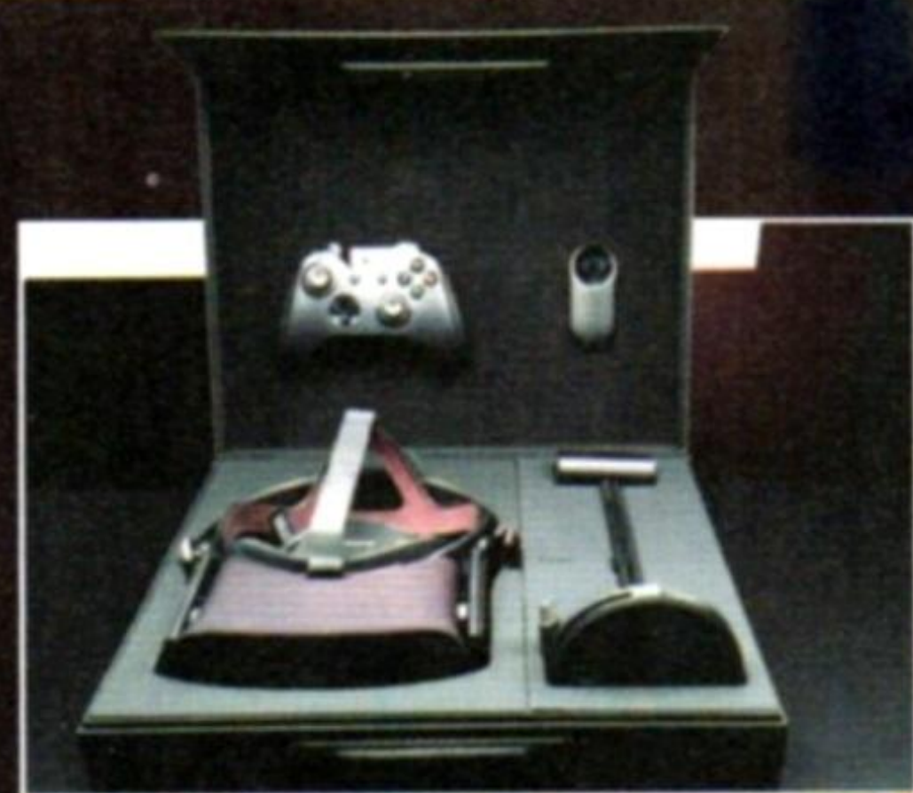
La dotazione degli Oculus Rift include gamepad, telecomando e supporto per il microfono.
