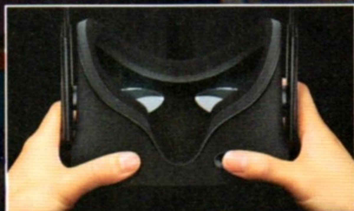
Gli Oculus Rift si indossano come una maschera da sub. Il display integrato offre una risoluzione di 2160 x 1200 pixel.
